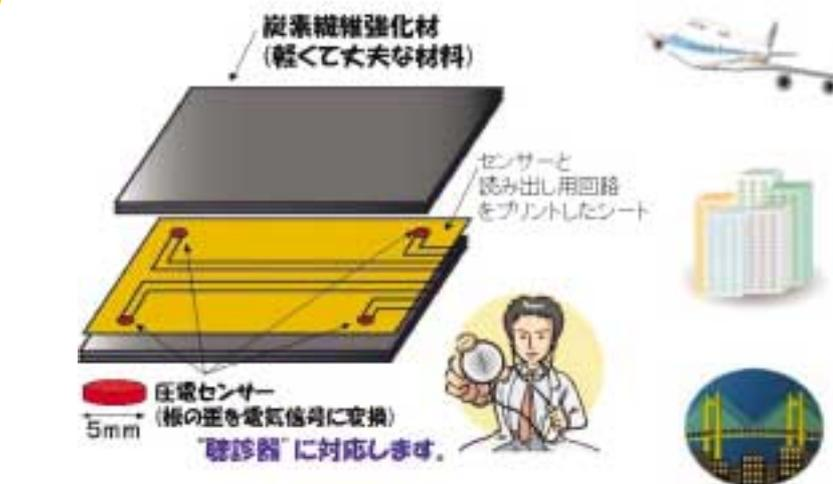
図1 スマートボードによる構造物のセンシング技術の開発
