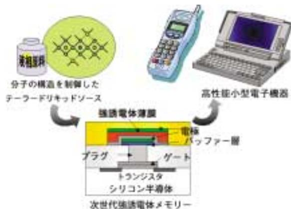
図1 次世代強誘電体メモリ用セラミックスの開発
