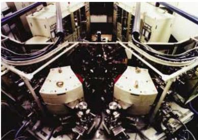
図2 正・負低エネルギーイオンビーム蒸着装置(PANDA)
