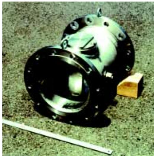
写真 標準型カルマン渦流量計の外観(手前から奥に向かって流体が通過する)
