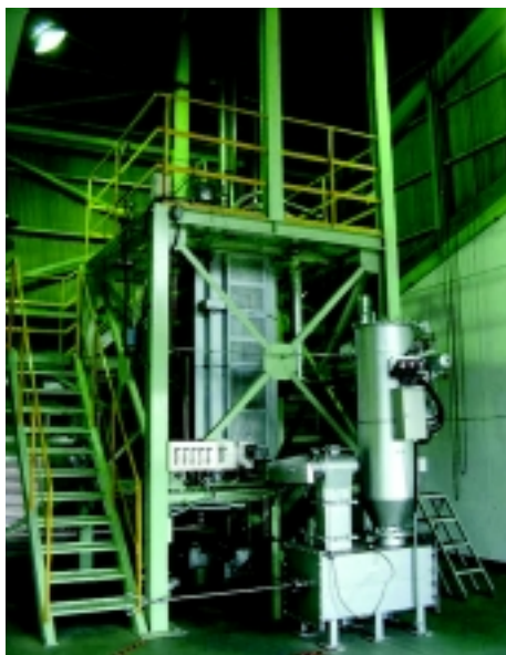
図2 超微粒子触媒を用いた化学合成法による大型連続式反応試験装置（昭和電工（株）生産技術センター内）
