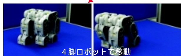
クローラ型移動ロボットから4脚歩行ロボットへの変形動作の実験の様子
