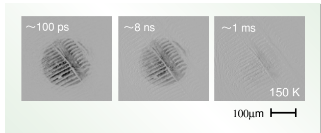
図6 時間分解分光法によって観測した光照射による軌道整列の融解。光照射の直後約 200 fs 程度で軌道整列の融解が起こり異方性の減少がみられる。
