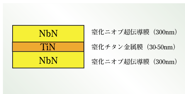
図2 今回開発したジョセフソン素子の構造(模式図)
