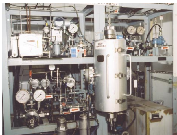
図2 軽油の品質改善用触媒の性能評価装置（中央が反応管部）
