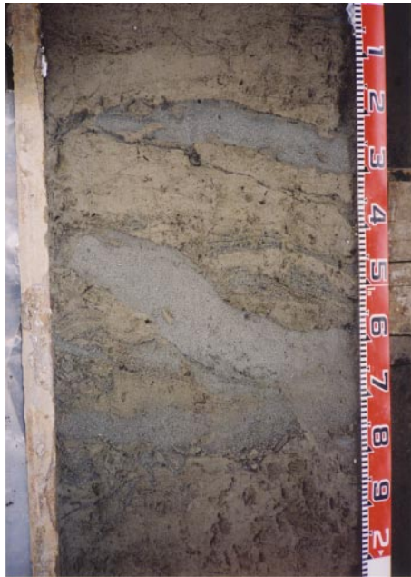
図5 剥ぎ取り直後の試料表面(コアNo.5) 深さ1-2mの範囲。上部の泥の中に貫入した砂が見える。大部分がほぼ水平に貫入したシルであるが、中央部には泥を斜めに切るダイクも認められる。
