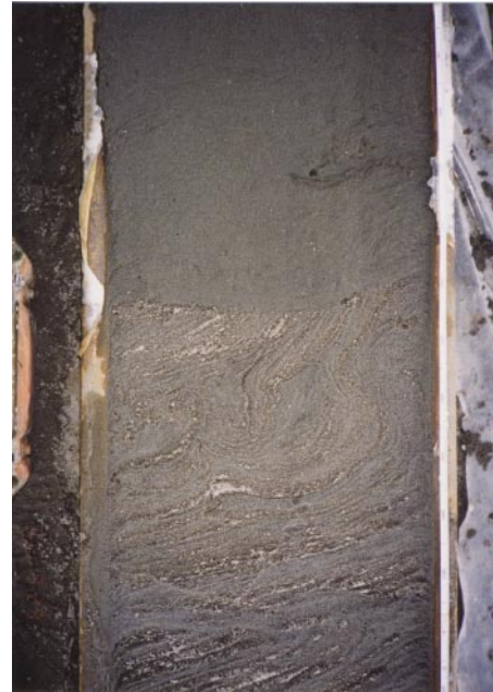
図6 剥ぎ取り直後の試料表面(コアNo.4) 深さ5-6mの範囲。上位の塊状の砂が液状化層で、下位の変形した粗粒砂層とは低角度の断層で接している。
