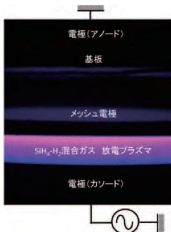
▲高効率アモルファスシリコン太陽電池の製膜に用いたトライオード型プラズマCVD
