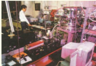
▲クラスターの構造を知るために、多光子共鳴イオン化質量分析法と赤外分光法を結合した手法を開発。
