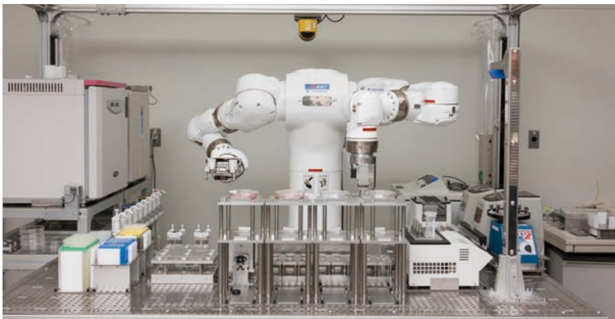
▲一台のロボットでさまざまな作業ができる汎用ヒト型ロボット「まほろ」
