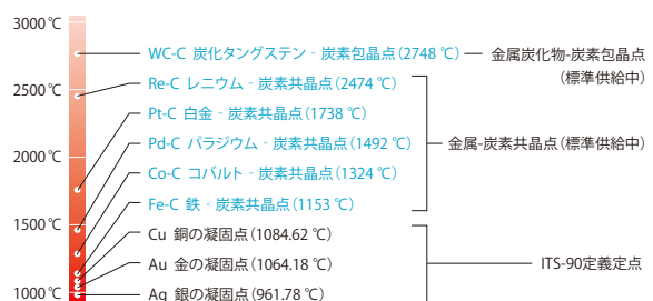
ITS-90定義定点と、産総研が標準供給している高温域の温度定点
