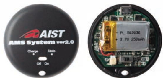
▲ 現在実用化されている直径約5 cmの筋音センサ
