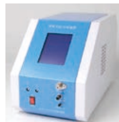
◀▶ がん由来の気体成分を測定するセンサ(左:高感度半導体式VOCセンサ)とそれを使ったがん検知のための濃度測定装置(上:呼気計測器のプロトタイプ) ※VOC:揮発性有機化合物
