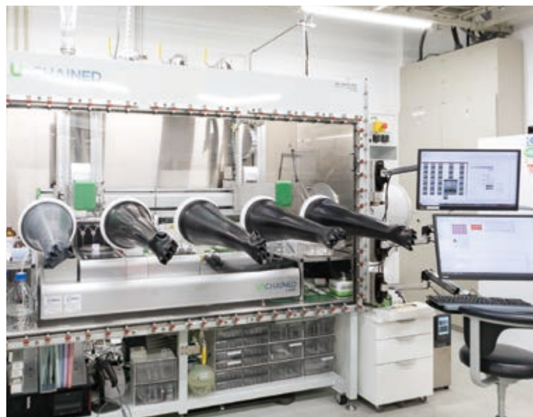
▲ 多数の触媒を全自動で合成することができるハイスループット触媒合成装置。一度に数十サンプルの触媒を調製できる。
