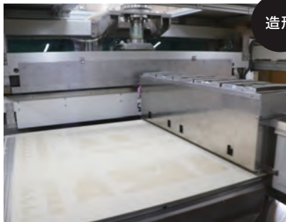
▲ 高速砂型造形装置による砂型造形
