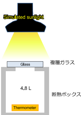
Fig. 6 擬似太陽光照射実験に用いた温度モニタリング装置。照射強度: 53.8 klx 複層ガラスのサイズ: 100 x 100 mm
