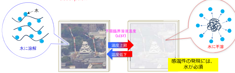
Fig. 3 温度応答性ポリマーを用いた温度スイッチング機能を持つ複層ガラス。
