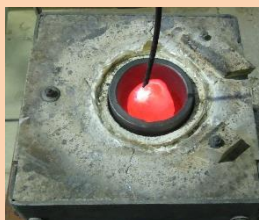
高周波溶解炉
