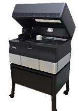
製品の形状確認や注型用マスター・モデル等の精細なモデルの造形に適しています。ただし、曲げ強度、耐熱性、耐候性が低いことにご留意ください。
