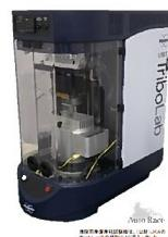
ボールオンディスク試験及びビンオンディスク試験により、材料表面の摩擦摩耗特性を評価します。1000°Cまでの高温環境下での試験が可能です。
