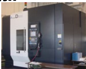
5軸制御立形マシニングセンタ等を用いた精密機械加工
