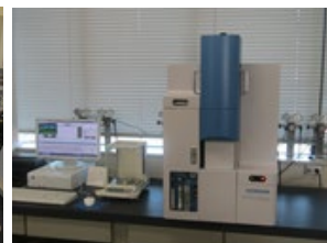
デジタルマイクロスコップ、炭素硫黄同時分析装置等を用いた精密測定
