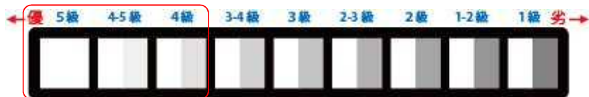
図1 基準となる汚染用グレースケール ※一般的な衣料品の品質基準では、4級以上が求められる
