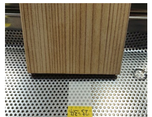
内装用塗装の不燃木材 ：乾湿繰り返し 25 回後、 滲み出しなし。
