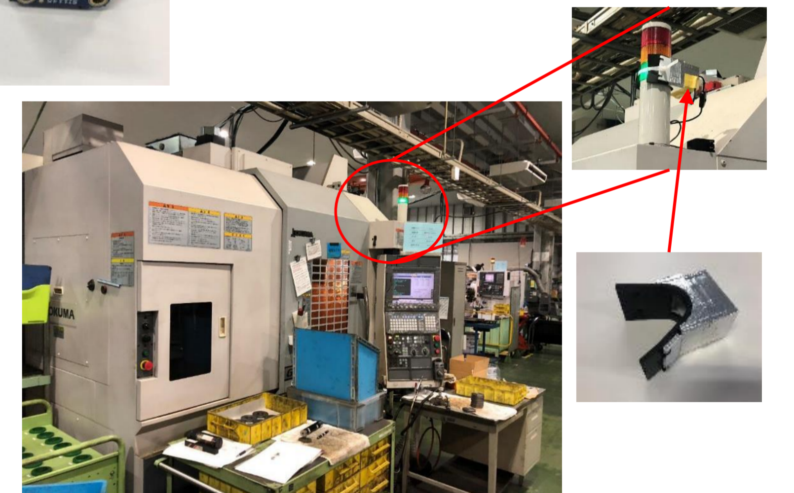
図2. 開発したシステム センサ及び制御PC (上) 工作機械へ取り付けられた様子及び取り付け治具 (右)
