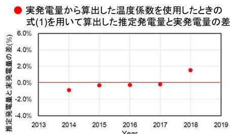
Fig. 2. SHJ太陽電池モジュールの推定発電量と実発電量の差(ただし、実発電量が欠測した日の推定発電量は加算していない。)
