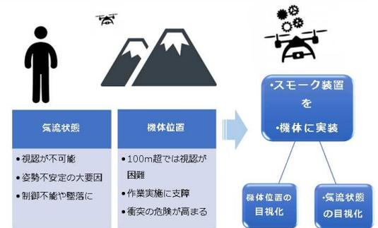
【図1】気流状態・機体位置の目視化装置
