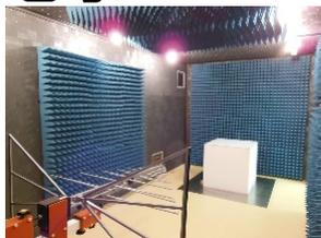
電磁妨害(EMI)試験機器
