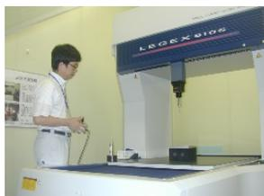
三次元測定機等を用いた機械計測
