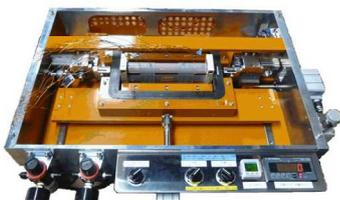
応力負荷型単板磁気試験器
