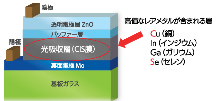
図1 CIS型薄膜太陽電池デバイスの構造
