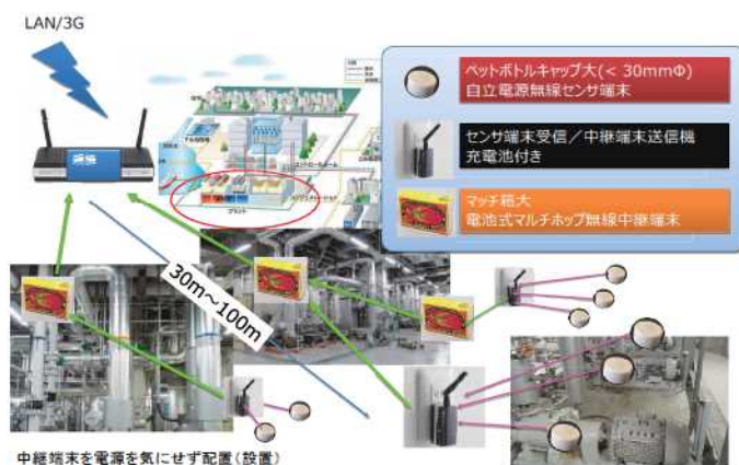
ポンプ監視の自動化システム
