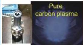
・ガスを用いずに、同軸銃等と高周波電力投入により放電維持に成功
