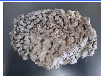
写真 バークペレットのクリンカ
