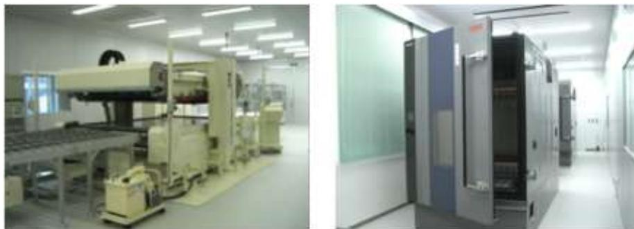
図2 産総研の太陽電池モジュール製造装置と屋内環境試験機
