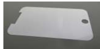
透明導電フィルムの切断例
