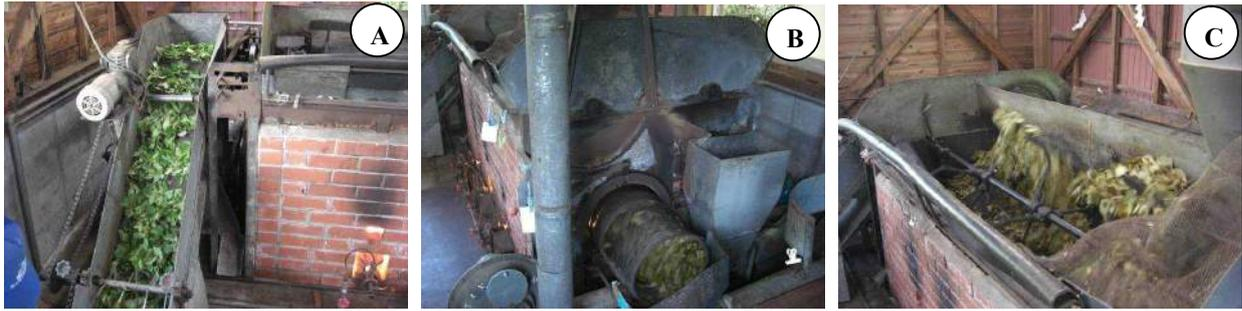
図3 ブルーベリー葉茶の加工において重要な殺青工程と釜炒り工程
