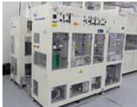
スピネッチング装置 ウェハを回転させながら片面をエッチングする装置です。保護膜なしで片面のみをエッチングできます。
