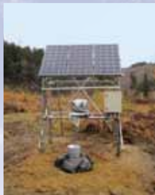
地表設置型 3成分地震計の設置状況
