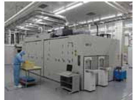
イオン注入装置 リンやボロンのイオンを加速して基板に打ち込むための装置です。精密な拡散の制御が可能です。
