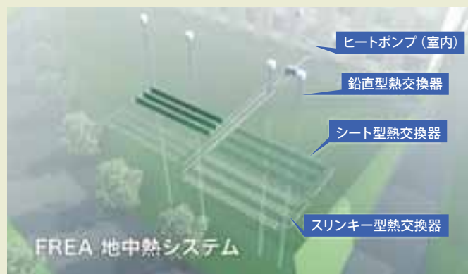
地下の熱交換器の設置状況
