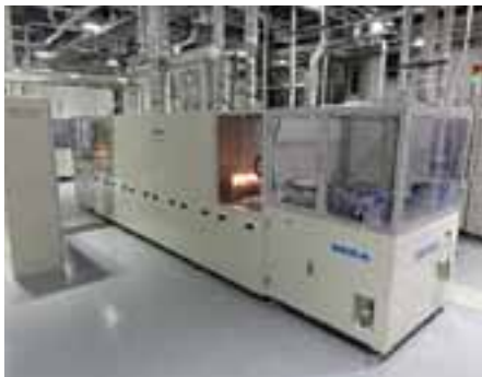
電極焼成炉 電極に用いる銀ペーストと拡散層とのコンタクトやアルミBSF層を形成するための装置です。
