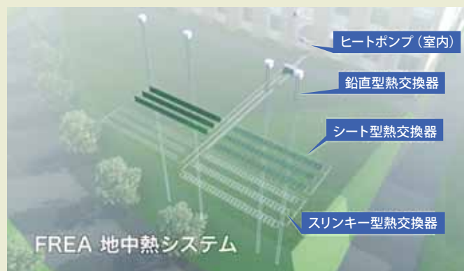
地下の熱交換器の設置状況
