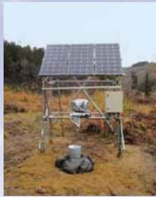
地熱井用坑井内 3成分地震計の設置状況
