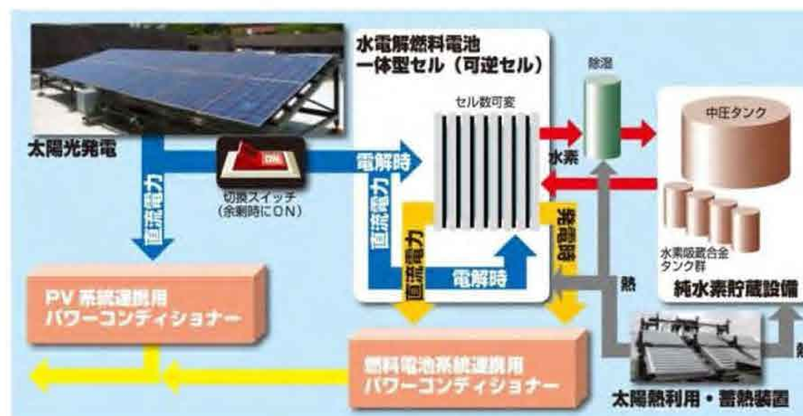
再生可能エネルギーによる水素製造・電気自動車を活用した平滑化実証
