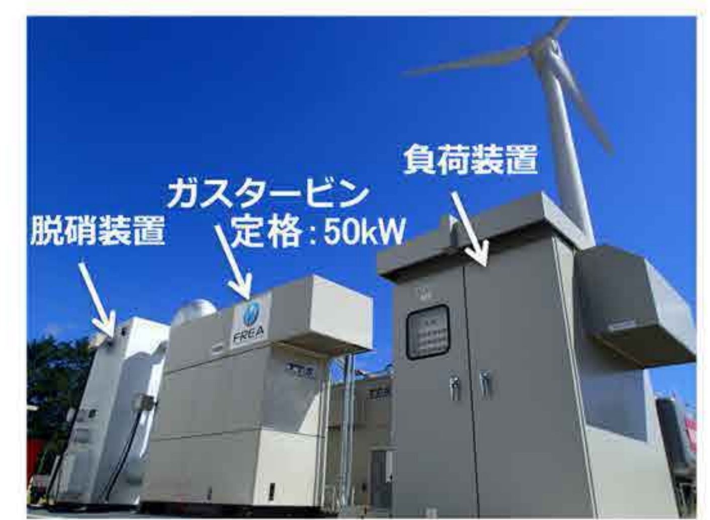
アンモニアガスタービン
