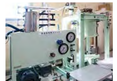
超高温坑内模擬装置
