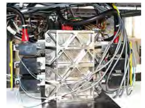
図1 セル数制御機能を持つ水電解装置(燃料電池機能付)
