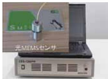
光MEMSセンサ多重化計測装置
