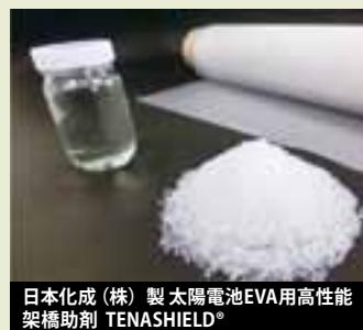
**太陽電池モジュール封止材用架橋材料**
