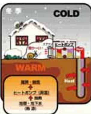
地中熱ポテンシャル = 热交換量、可能採熱量、適度
