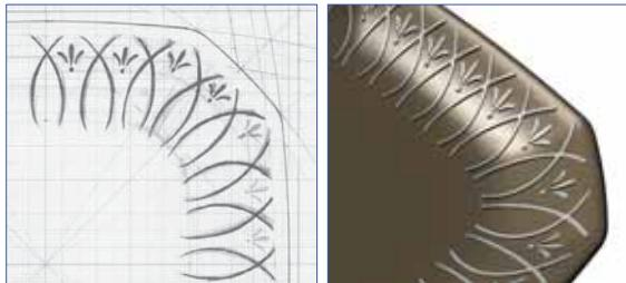
図面や寸法を基に3次元CADデータを作成します
