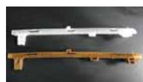
試作した自動車窓枠部材
