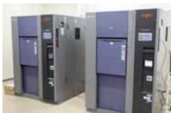
製品の急激な温度変化に対する耐性を評価できる
