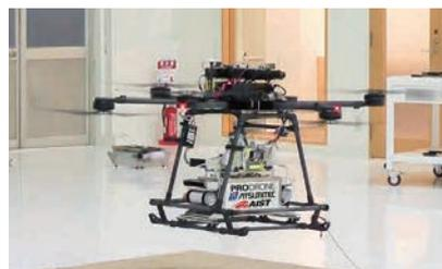
多様な燃料が使える燃料電池と、全固体電池で実現
