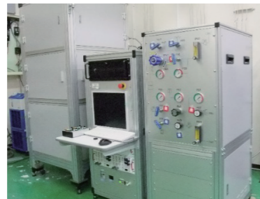
半導体レーザー加熱式単結晶製造装置 (高圧・傾斜照射型)
