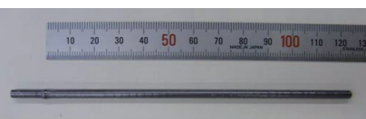
次世代材料 BiFeO 3 の結晶育成試験 (上) 育成の様子 (下) 育成結晶
