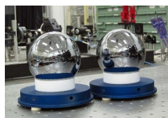
プランク定数測定に用いたシリコン単結晶球体
