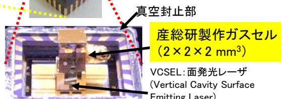
プロトタイプ原子時計内部構造(40×40×18 mm 3 )
