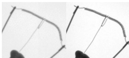
図1 従来型X線検出器(左)と本研究で開発したX線FPD(右)で撮影した電球フィラメント部
