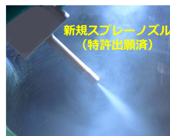
微細液滴化能力と目詰まり耐性の両立を実現可能なノズルを開発
