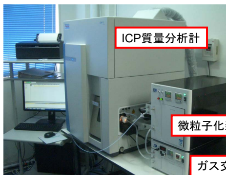
微粒子化・ガス交換・ICP質量分析法による 環境大気中ガス状水銀 [Hg 0 (g)] 測定 (例)
