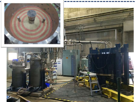
図1 大型出砂評価試験装置と(左上)出砂現象確認のための色付き土層
