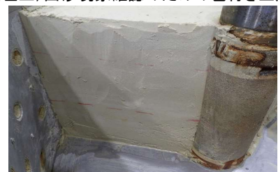
図2 試験後の土層内の様子：出砂現象がおきていないため色付き土層に乱れが観察されていない
