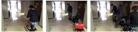
ハード連結型台車 (左から1人乗車, 荷物運搬, 3人連結)
