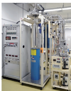
揮発性有機化合物等の値付けに用いる断熱型熱量計
