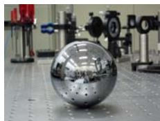
1 kgの ^{28}\text{Si} 結晶球
