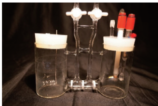
ひ素標準液等の値付けに用いる電量分析装置
