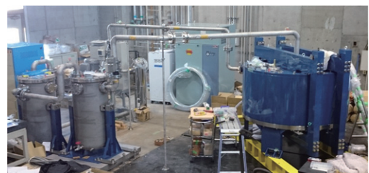
図1 出砂対策技術検討のために開発した出砂評価試験装置
