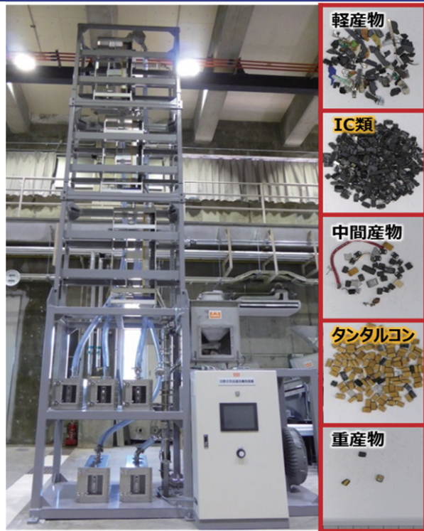
図1 四管式気流選別機(実証機)と電子素子の5成分選別例
