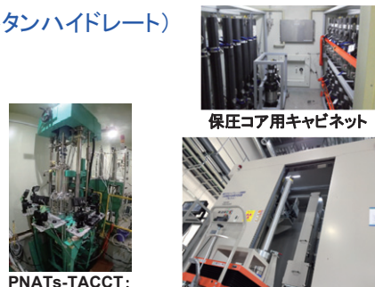
保圧コア用キャビネット PNATs-TACCT: 三軸型保圧力学装置 PNATs-X: 大型X線CT装置 図1 開発した保圧コア評価装置群の一部
