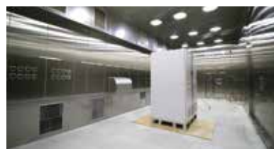
環境試験室恒温恒湿槽
