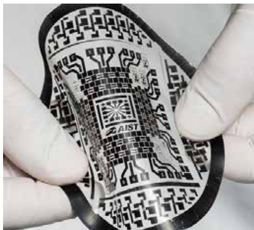
電極の絶縁膜も基板もすべて柔らかく曲げ伸ばし可能な材料で構成
