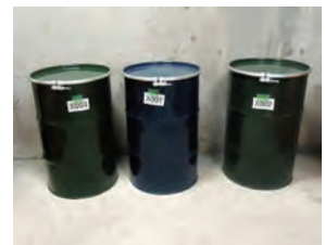
ドラム缶に詰められ保管中の PCB 廃棄物
