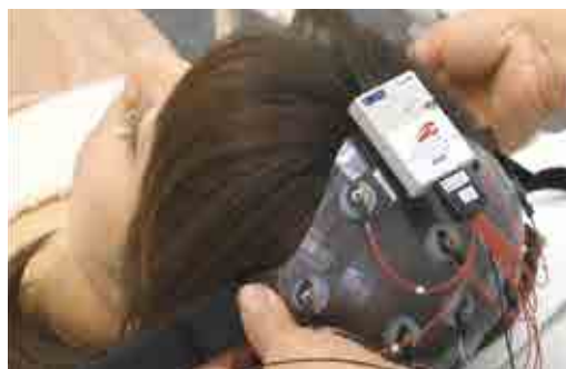
ニューロコミュニケーターの装置(脳波計測用ヘッドギア)
