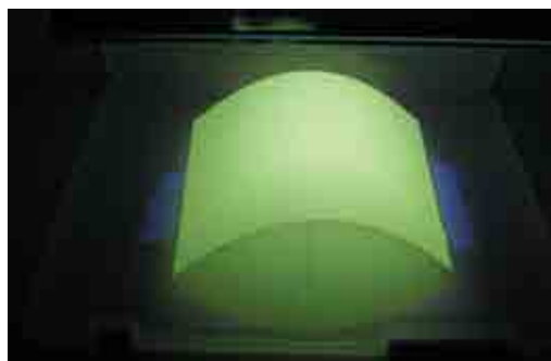
光MOD法により作製した高輝度蓄光フィルム
