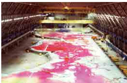
着色した水を流した瀬戸内海大型水理模型(汚染拡散シミュレーションの様子)
