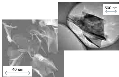
合成スメクタイトの走査型電子顕微鏡(SEM)写真(左)と透過型電子顕微鏡(TEM)写真(右)
