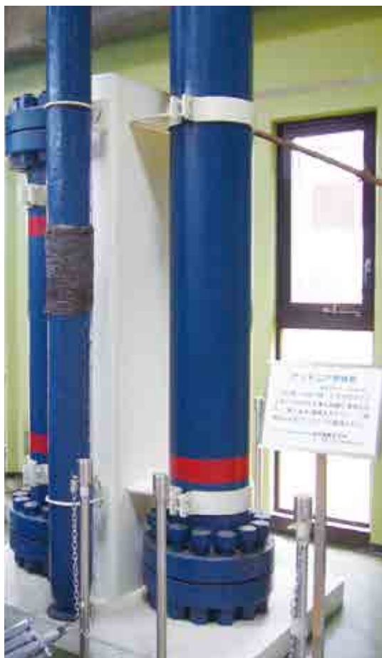
1926年頃に使われた高さ約3 mのアンモニア合成管
