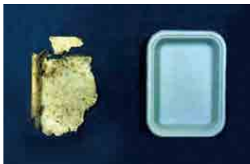
土壌中に半年間埋設しておくだけで分解されたプラスチック
