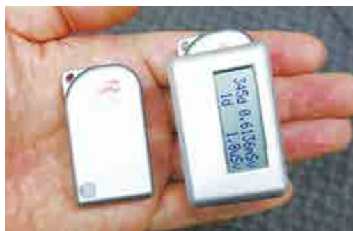
1年以上電池交換なしに使用できる小型線量計(左)とその表示器(右)
