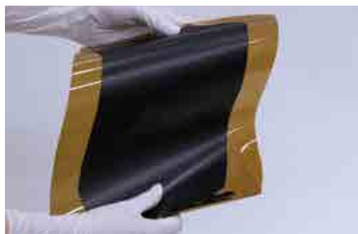
開発したSGCNT系水性塗料を用いてポリイミドシートへ形成した塗布膜
