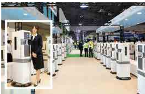
見本市セミコンジャパンに展示した70台のミニマル装置群。 1台のサイズは小柄な女性よりも小さい高さ(144 cm、幅30 cm、奥行45 cm)
