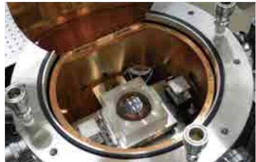
同位体濃縮シリコン結晶球の直径を測るレーザー干渉計
