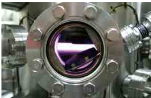
プラズマ援用化学気相堆積(PECVD)による薄膜シリコンの製膜
