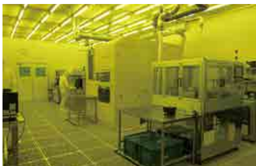
SiC 3.3 kVスイッチングトランジスタの試作に使用した装置群
