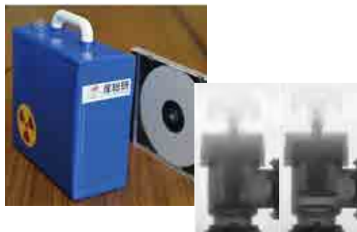
パルスX線源(120 kV)とサイズ比較のためのCDケース(左)と 金属製バルブのX線透過写真(中:バルブ閉、右:バルブ開)
