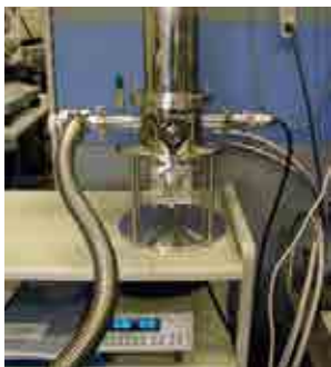
小型冷凍機を用いたデスクトップ型ジョセフソン電圧標準システム
