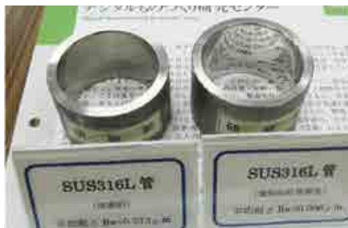
電解砥粒鏡面研磨技術による研磨前(左)と研磨後(右)のステンレス管内面
