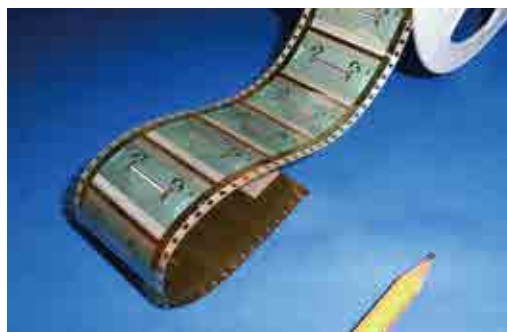
開発した絶縁保護膜用樹脂を使用したフレキシブル基盤
