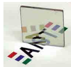
鏡の状態(左)と透明な状態(右)に切り替わる自動調光ガラス
