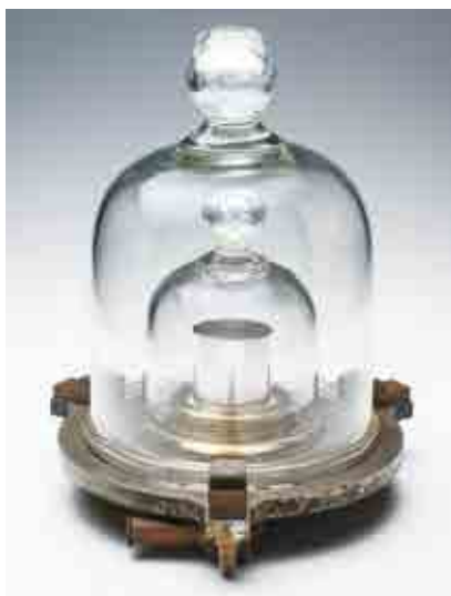
二重のベルジャー内に保管されている「キログラム原器」
