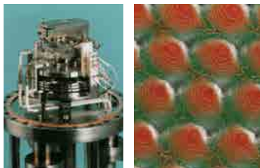
走査型トンネル顕微鏡(STM) (左)によるグラファイト(黒鉛)の表面写真(右)
