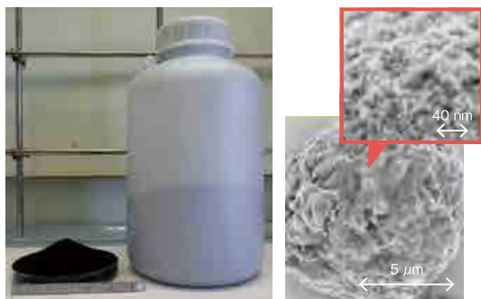
プルシアンブルーナノ粒子吸着材(左)の走査型電子顕微鏡(SEM)写真(右)
