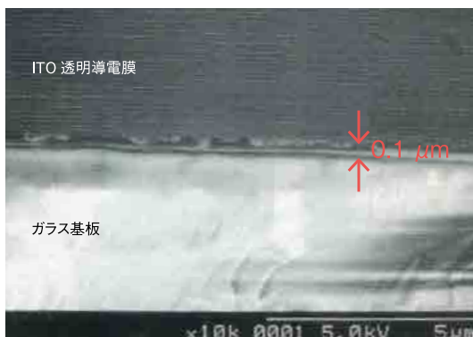
ガラス基板上に形成された酸化インジウム透明導電膜(ITO)
