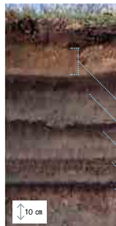
湿地での掘削調査から得られた地層断面
