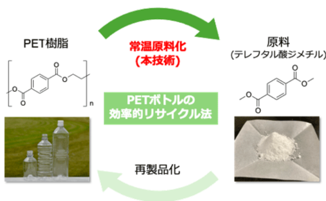
本技術によるペットボトルの効率的リサイクル法の概要
