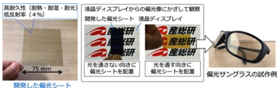
開発した低反射率で高耐久性のワイヤーグリッド偏光シート
