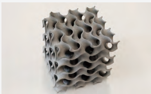
金属3Dプリンタで造形した高放熱性形状の金属部品
