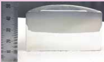
サーボプレスによる異種材料の接合
