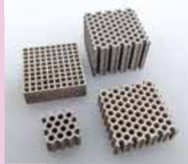
金属3Dプリンタによるタングステンの造形
