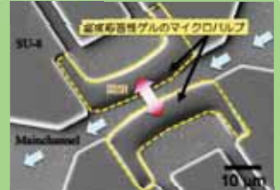
微細加工可能な温度応答性ゲルで製作したマイクロバルブ
