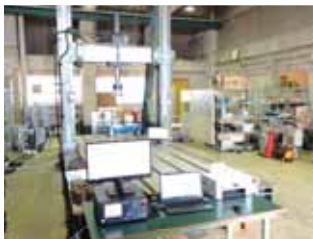
大型工業製品の強度試験を行うことができる大型構造物試験機
