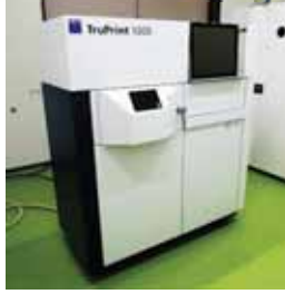
金属積層造形装置 (パウダーベッド方式)
