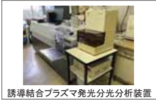
誘導結合プラズマ発光分光分析装置
